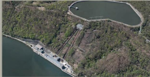
Am Nordufer von Ruhr und Hengsteysee bzw. im Ardey-Steilhang (somit auf dem Herdecker Stadtgebiet) befindet sich das „alte Koepchenwerk“ mit zugehörigem Oberbecken im Kleff-Berg. Es ist eines der beiden ersten großen Pumpspeicherkraftwerke in Deutschland und diente seinem Zweck bis 1994.
